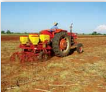
'n Twee-ry geen-bewerking planter in aksie. Let op die ongeploegde oppervlak.
